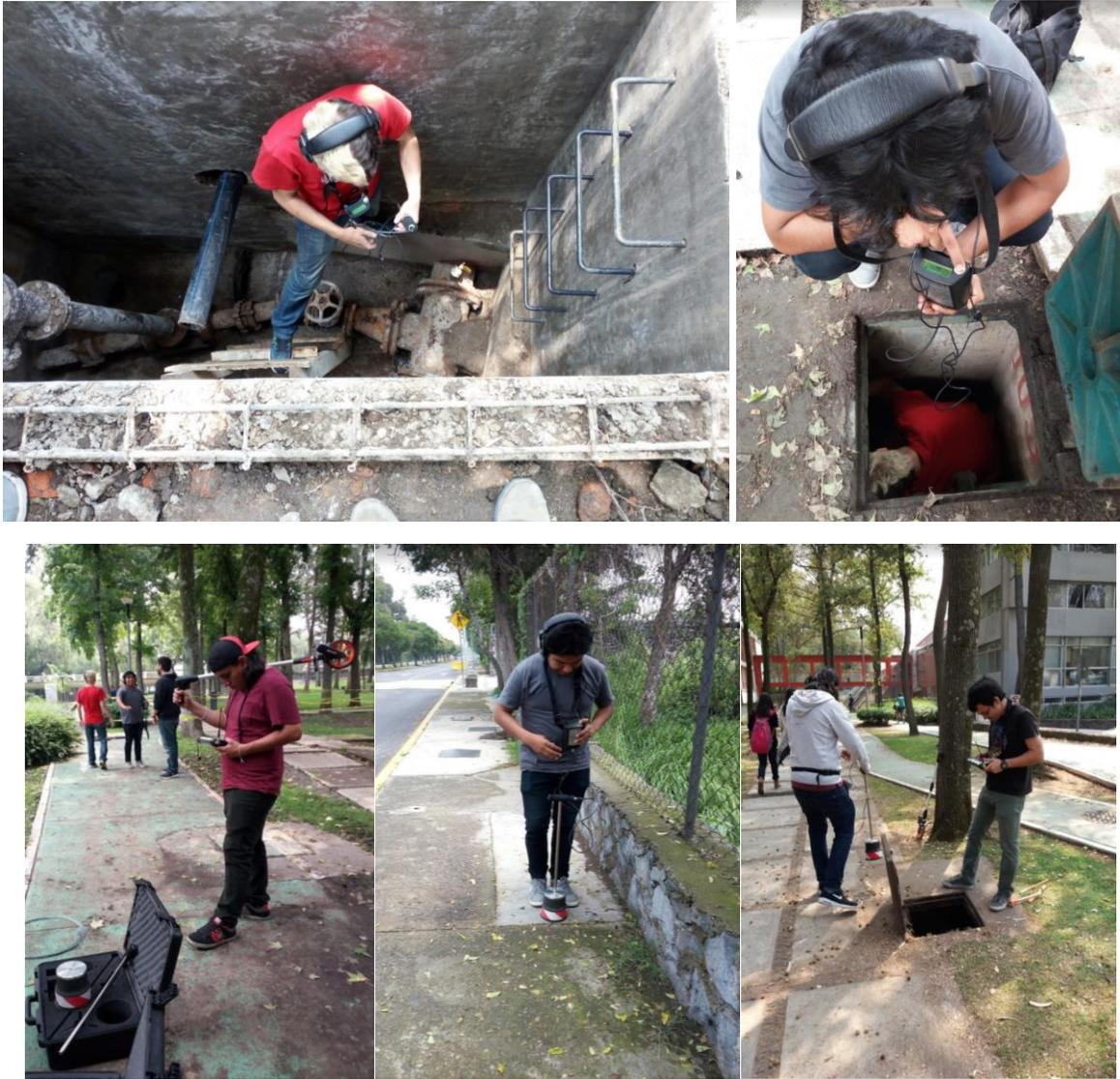
*Figura 13. Trabajo de localización de fugas con geófono y correladores*
