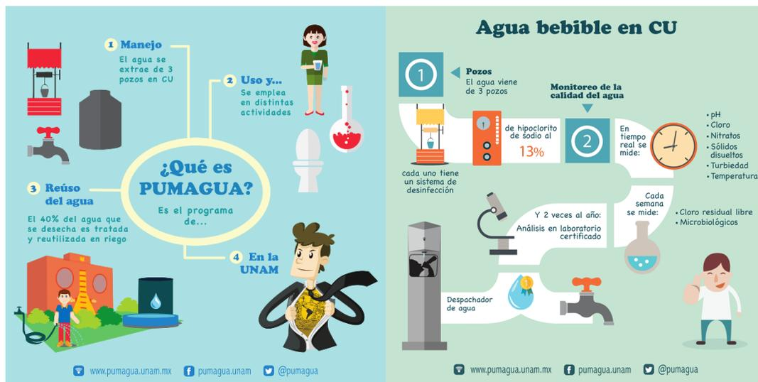
Figura 47. Infografías de PUMAGUA sobre los componentes del programa y el sistema de desinfección y monitoreo de agua para uso y consumo humano.
