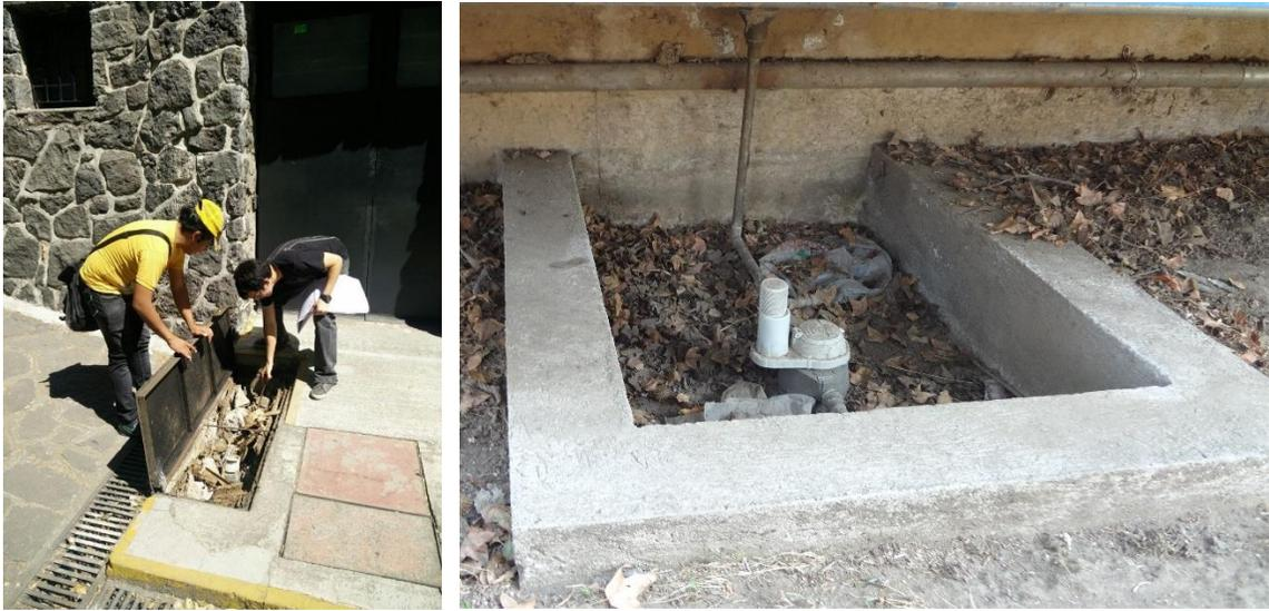
Figura 5. Trabajos en campo para bajar la información de los micro medidores
