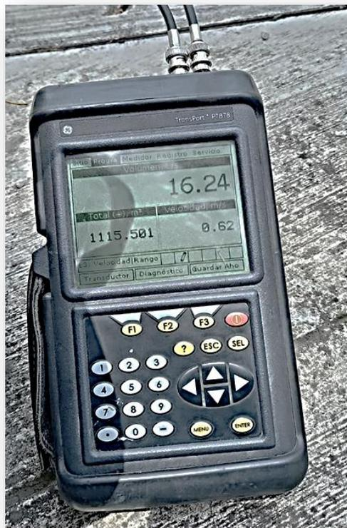
Figura 24. Medidor Ultrasónico Portátil
