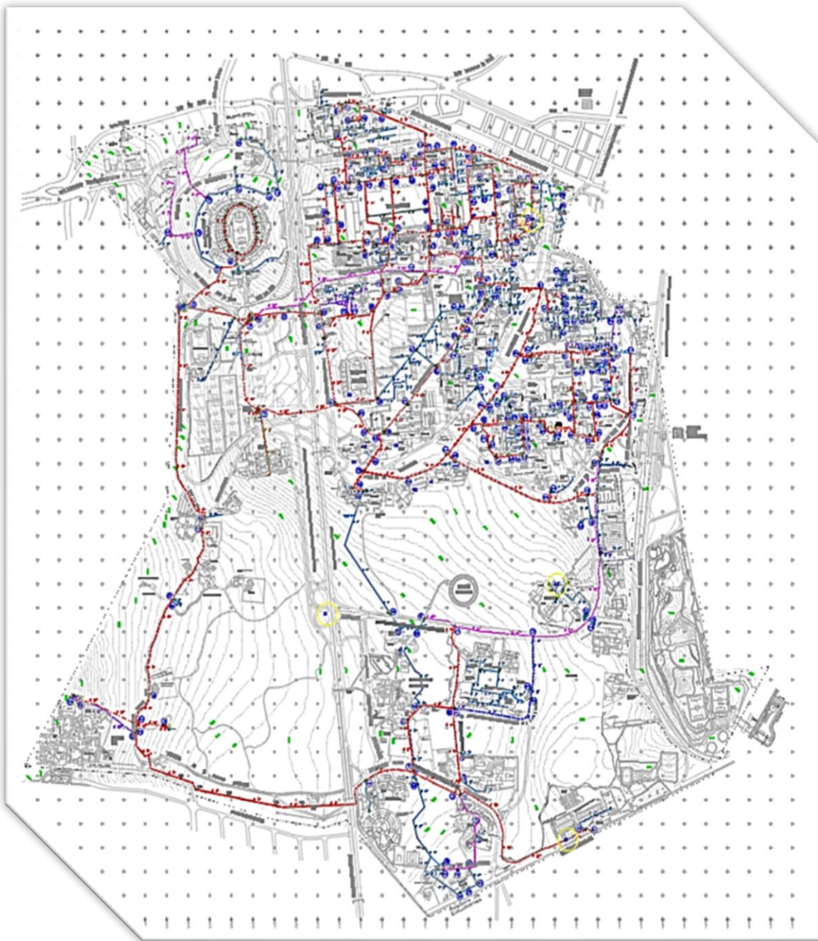
ILUSTRACIÓN 2. Mapa de la red de agua potable de C.U.
